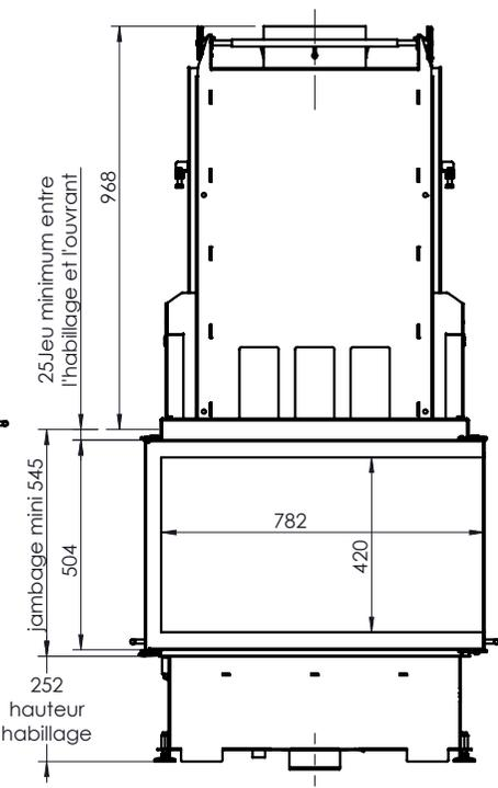
surélévation minimum en cas de raccordement par le coté : 155
